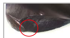
Ausbrüche aufgrund zu hoher Belastung
