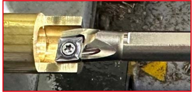
Schwingungsgedämpfte Bohrstange Mindestbearbeitungsdurchmesser 10 mm
