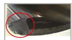
Abplatzung durch zu geringe Stabilität der Geometrie
