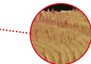
Niedrige Oberflächengüte (Riefenbildung) bei geringer Schnittgeschwindigkeit speziell im Zentrum des Werkstücks.
